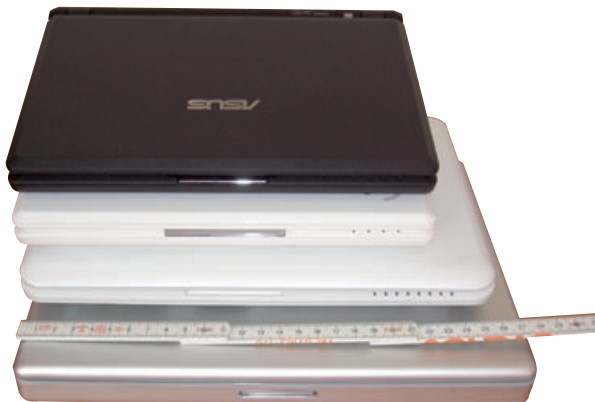
Der EeePC 900A (weiß) unterscheidet sich zugeklappt nur durch die größere Tiefe vom alten 701 (schwarz, ganz oben), bei Display, Touchpad und im Inneren hat sich jedoch viel getan. Eine Größenklasse darüber spielt das zehn Zoll große Akoya E1210, das in der Breite fast an das PowerBook ganz unten heranreicht.
