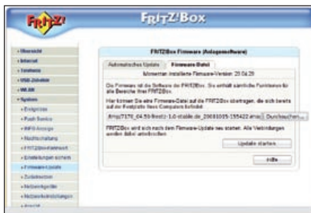
Geflasht wird über das Webinterface der FRITZ!Box, was auch über WLAN funktioniert.
