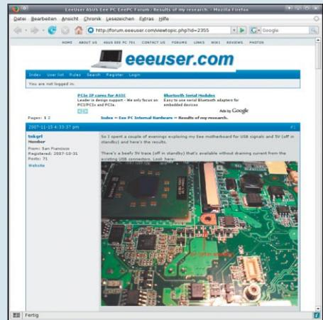
Garantieverlust garantiert: „tnkgrl“ hat Löt-punkte für interne USB-Geräte identifiziert, die den Einbau zusätzlicher Geräte erlauben.
